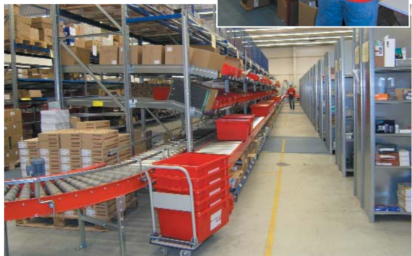
j Die Aufträge werden über 270 m Fördertechnik mit sechs „Bahnhöfen“ und diversen Kontrollen abgearbeitet.
